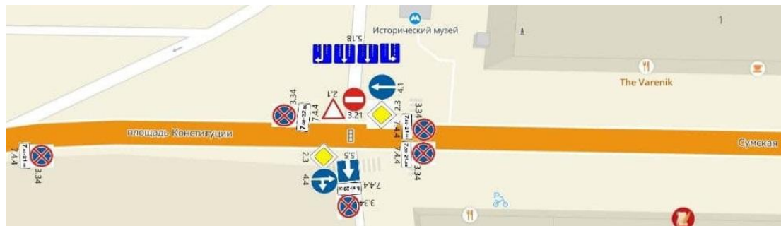
Схема дислокації дорожніх знаків на перехресті вул.Сумська х пл.Конституції
