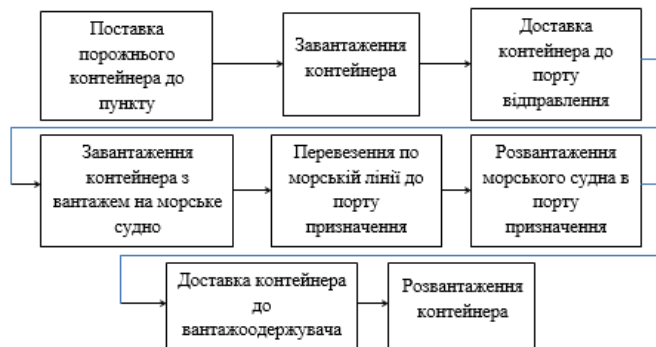
Рисунок 1 – Схема технології доставки зернових вантажів у контейнерах
