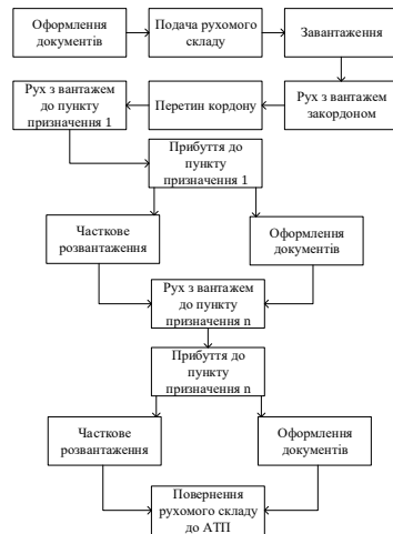
Рисунок 1.1 – Схема послідовності елементів транспортного процесу при доставці вантажу за допомогою однорівневої моноцентричної розподільчої системи
