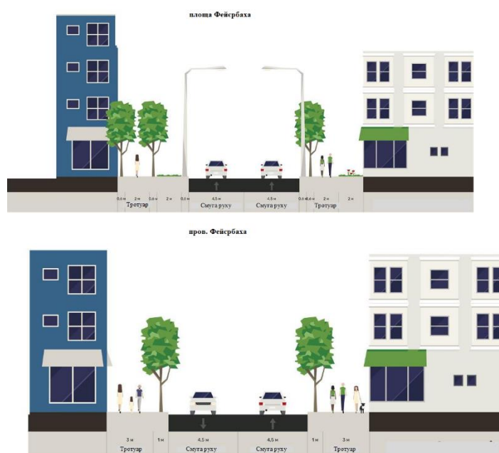
Рисунок 13.3– Існуючий поперечний профіль елементів досліджуємої ділянки ВДМ
