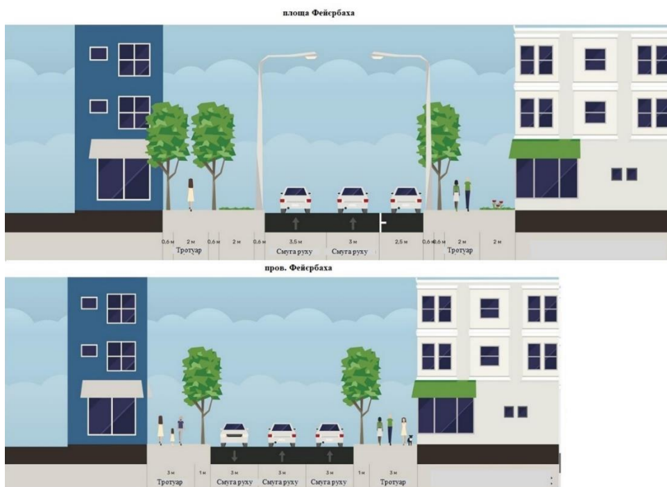
Рисунок 13.6 – Запропоновані поперечні профілі елементів досліджуємої ділянки ВДМ
