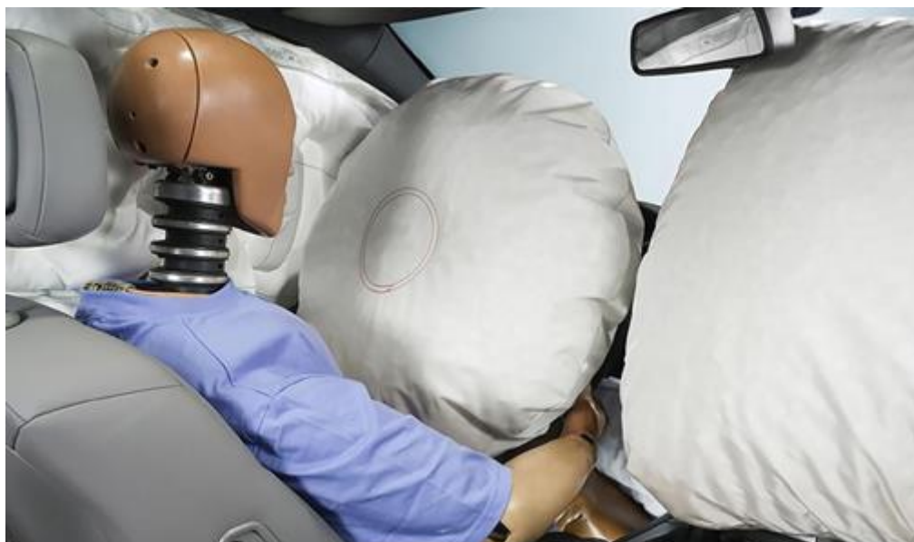
Рисунок 1.2 – Подушка безпеки після спрацювання
