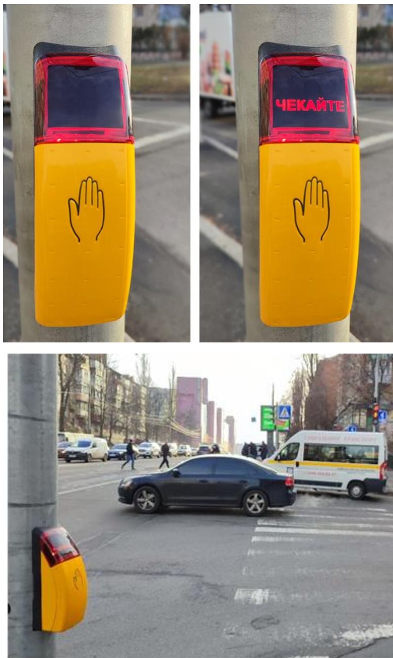
Рисунок 11.1 - Комплекс звукового та тактильного дублювання сигналів пішохідних світлофорів в місті Києві [106]
